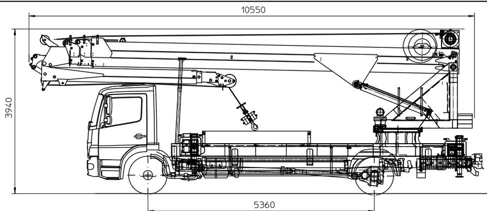
Der Böcker Autokran AK 44/4000 SPS wird auf einem LKW z.B. DB 1523/4x2/5360 aufgebaut. Über vier hydraulisch einzeln steuerbare L-Stützen wird das Fahrzeug abgestützt. Zur Kontrolle der waagerechten Aufstellung ist eine Dosenlibelle angebracht.
